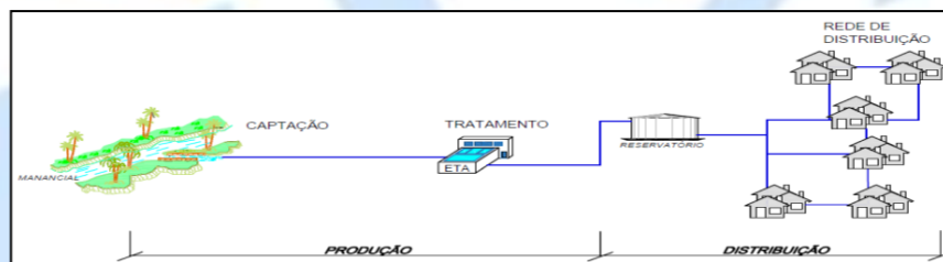
FIGURA 1 – ESQUEMA SIMPLIFICADO DE UM SISTEMA DE ABASTECIMENTO
